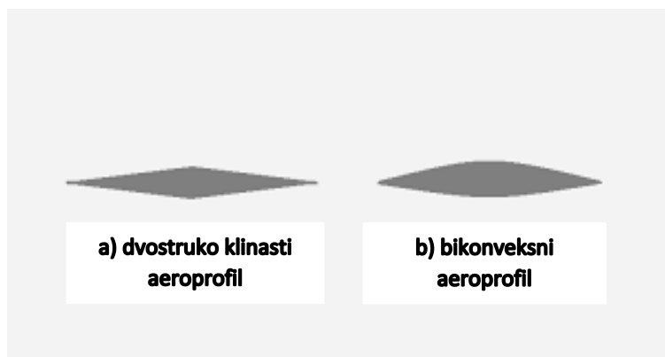
Slika 3. Dvostruko klinasti i bikonveksni aeroprofil
