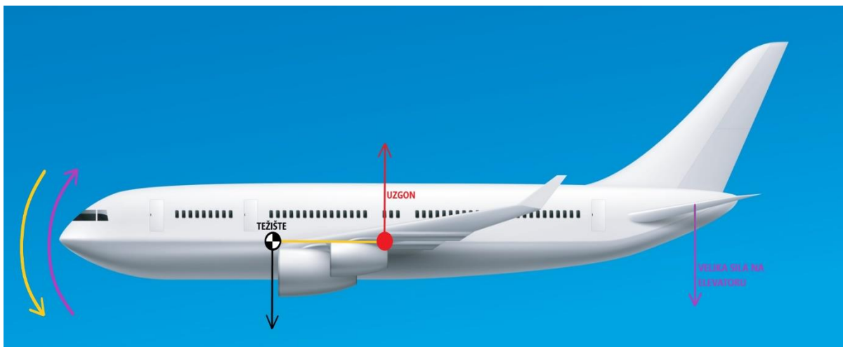
Slika 8. Težište pomaknuto prema prednjoj granici Izvor [9]
