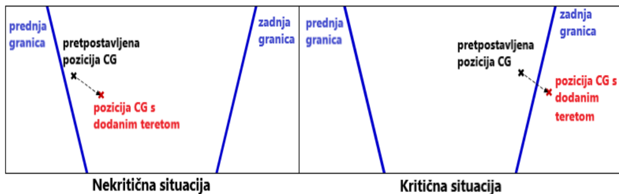
Slika 13. Nova pozicija težišta uslijed pozitivnog momenta
