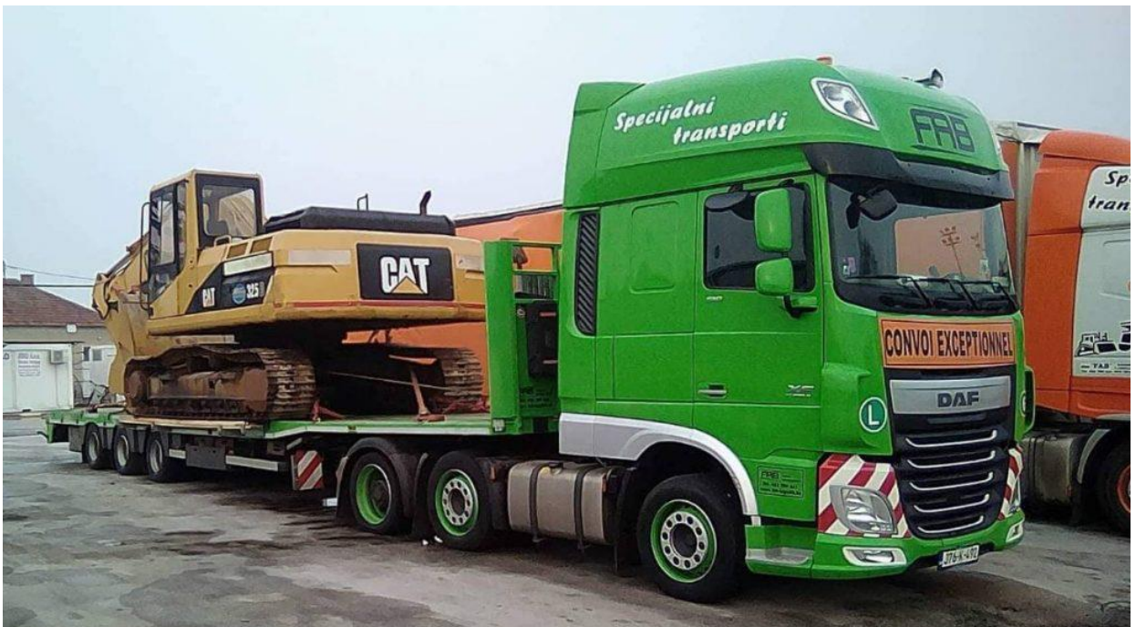
Slika 10. Tegljač s tri osovine u kombinaciji s prikolicom s tri osovine
