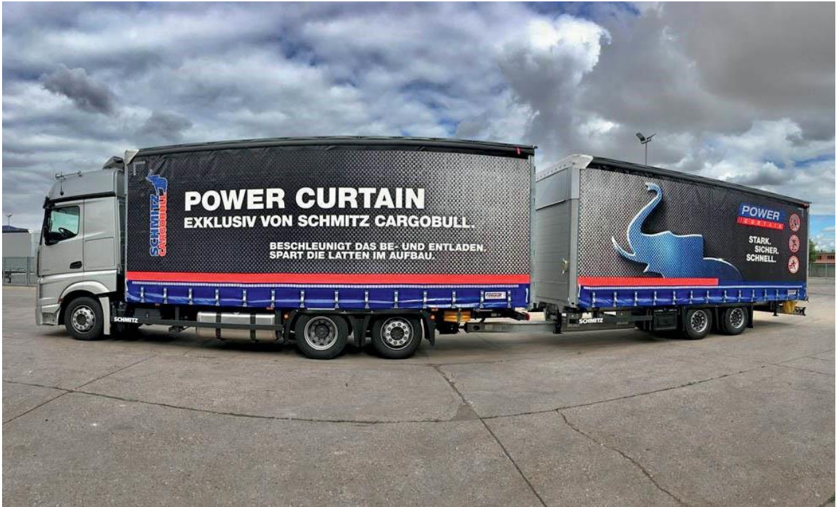
Slika 8. Kamion s tri osovine u kombinaciji s prikolicom s dvije osovine
