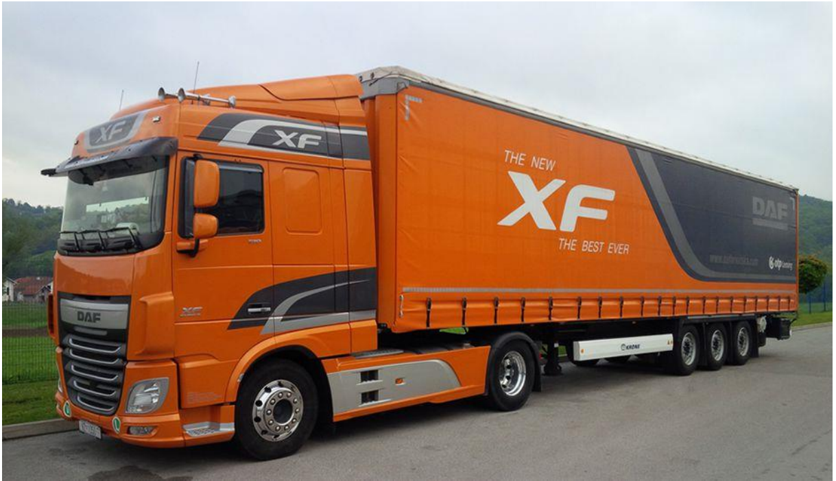
Slika 9. Tegljač s dvije osovine u kombinaciji s prikolicom s tri osovine
