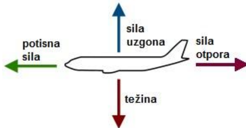
Slika 2. Djelovanje sila na zrakoplov tijekom ustaljenog horizontalnog leta [2]
