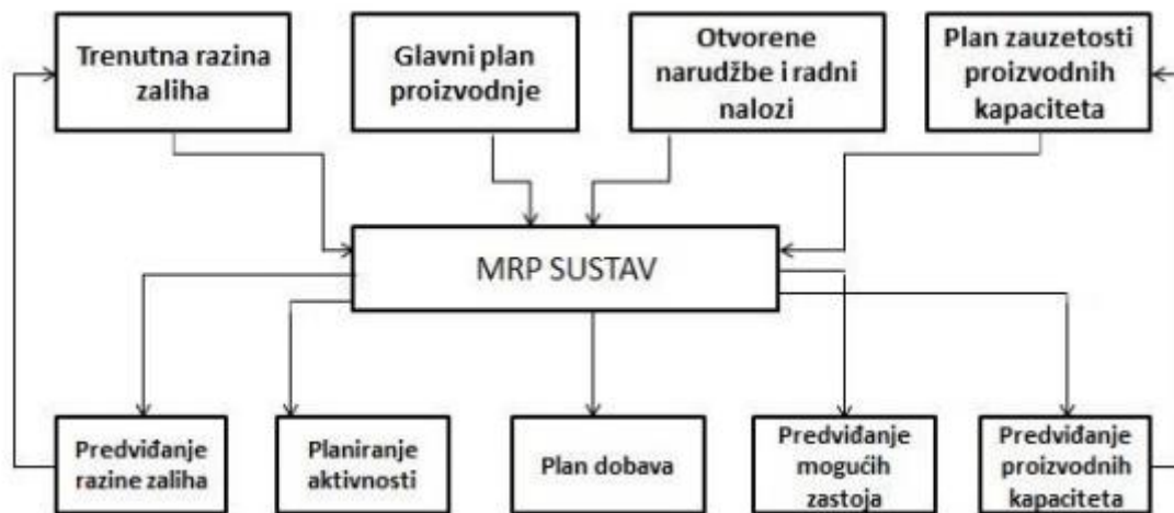
Slika 4 Prikaz sastavnih dijelova MRP sustava
