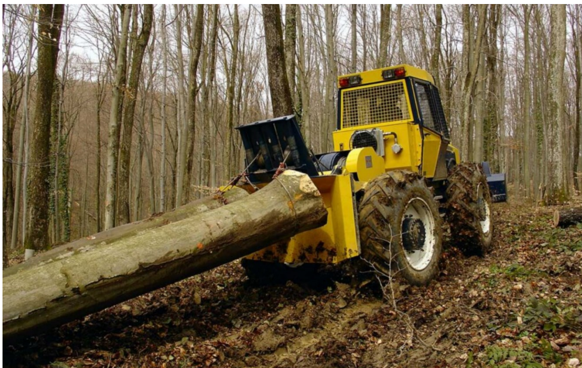
Slika 6. Prijenos trupca skiderom EcoTrac 120V [5]
