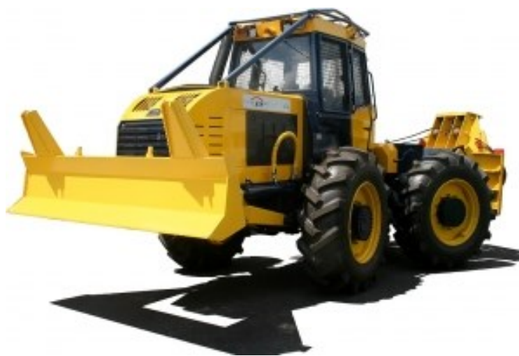
Slika 1. Šumski zglobni traktor EcoTrac 140V [2]
