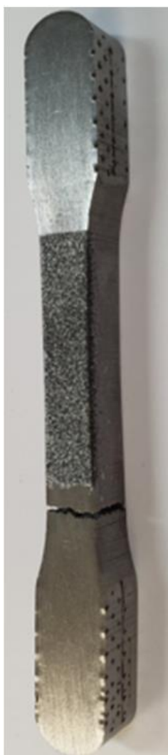
Slika 77. Lokacija pojave loma epruvete od sinteriranog čelika u statičkom vlačnom testu
