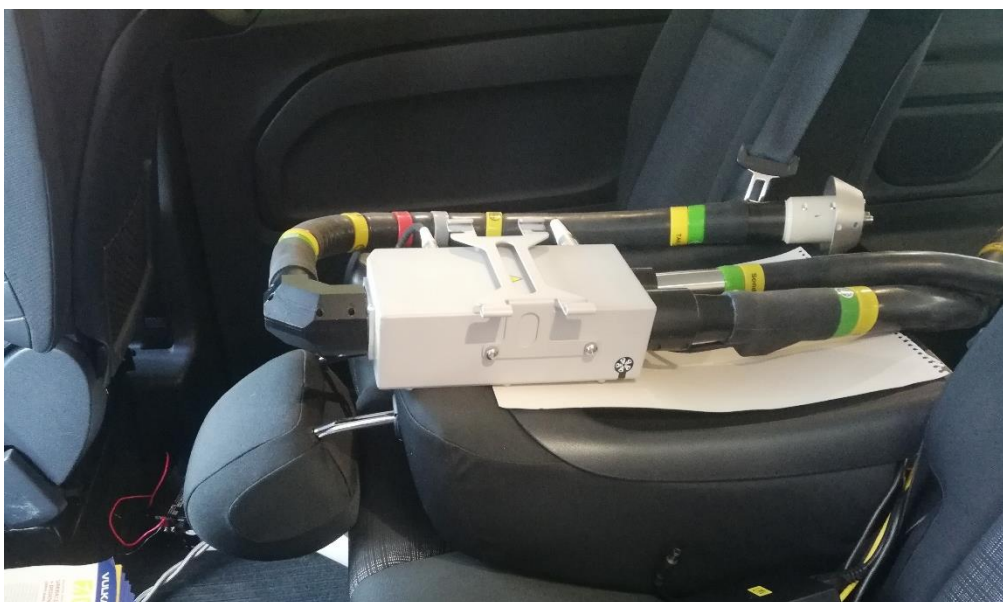
Slika 4.4. Grijane cijevi povezane s uređajem za razrjeđivanje
