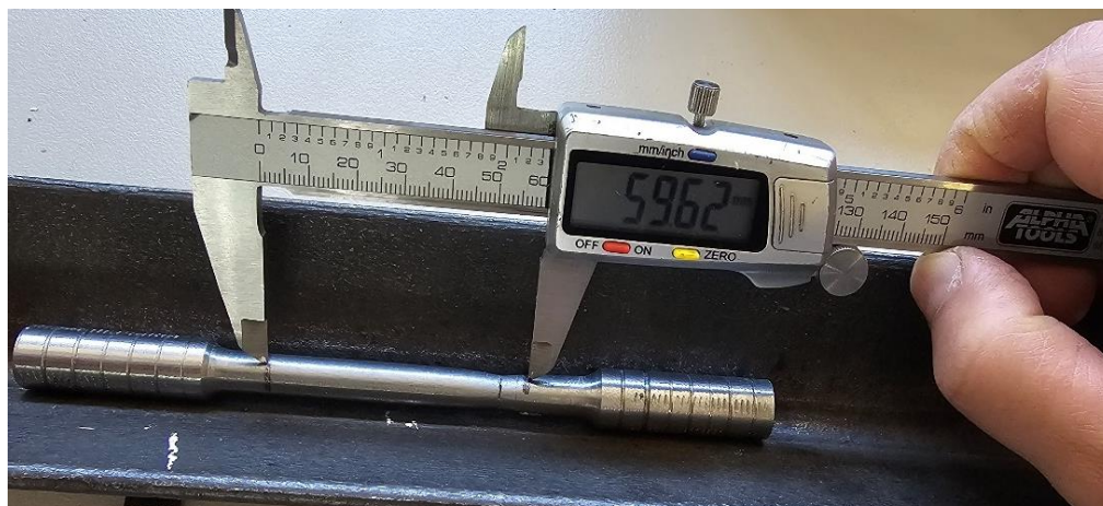
Slika 20. Mjerenje produljenja nakon loma L_u
