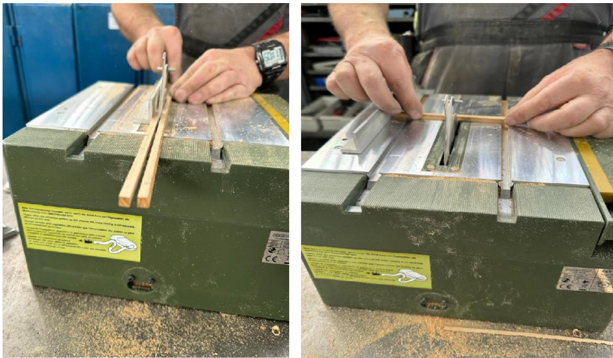
Slika 32. Rezanje uzoraka za savojno ispitivanje
