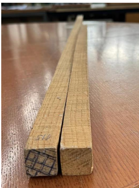
Slika 31. Subfosilno drvo jasena za ispitivanje
