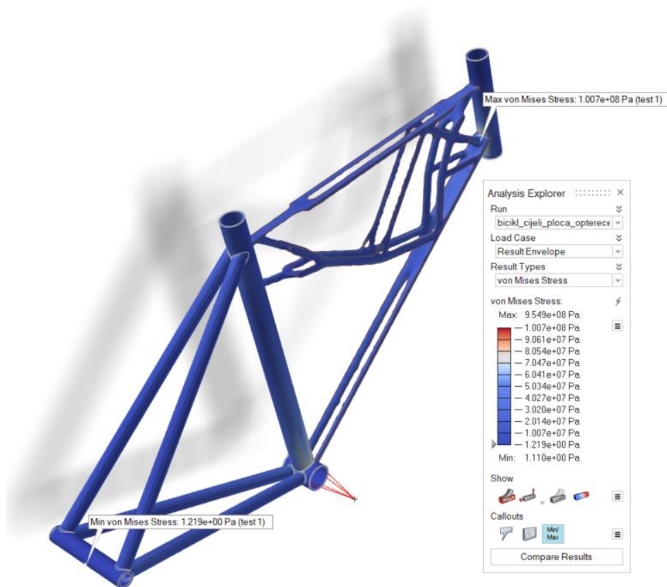
Slika 57. Rezultati testiranja optimiranog okvira, naprezanje
