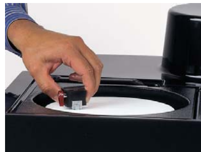
Slika 15. Uređaj za ručno brušenje i poliranje [9]
