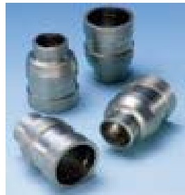
Slika 6. Sonde za ultrazvuk (NDT) [8]
