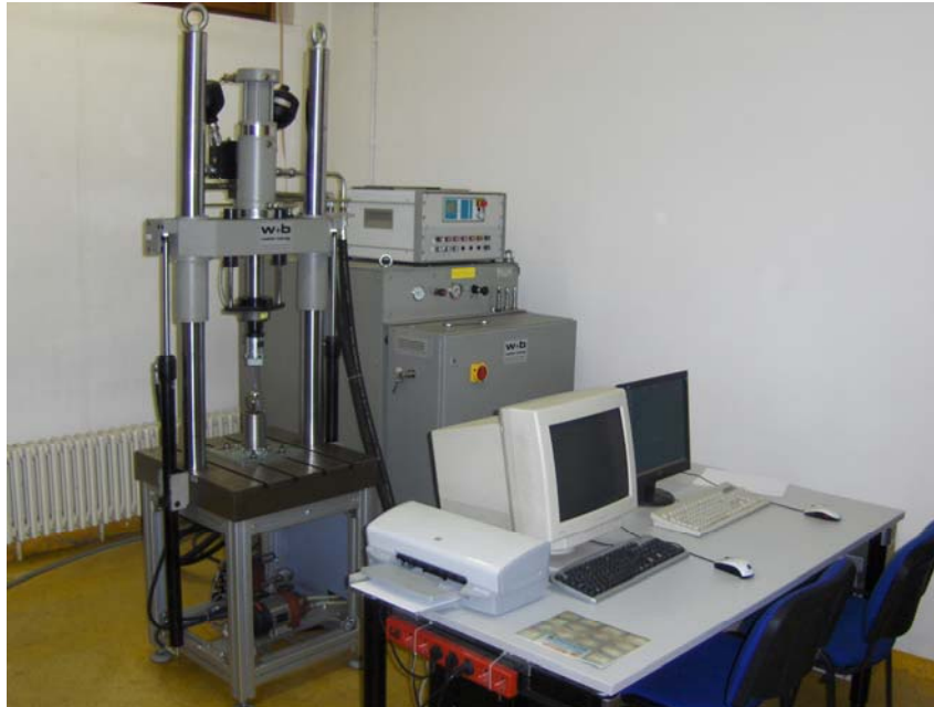
Slika 35. Servohidraulička kidalica LFV 50-HH s upravljačkom jedinicom
