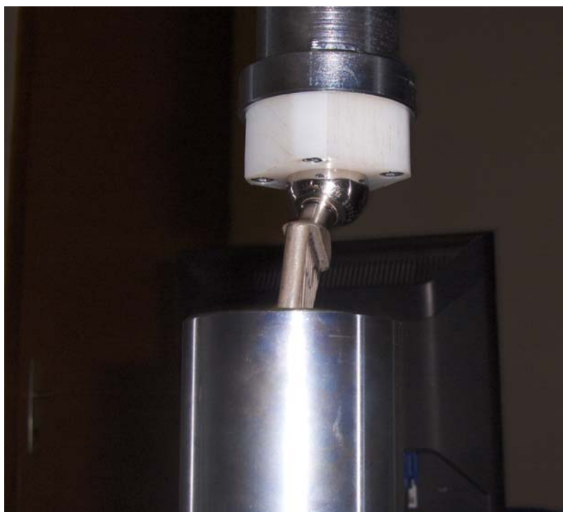
Slika 36.(B) Nalijeganje konektora na glavu endoproteze
