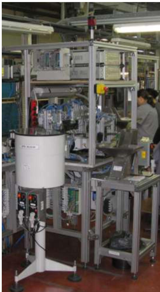
Slika 5. Automat za montažu čahure, opruge i ležaja
