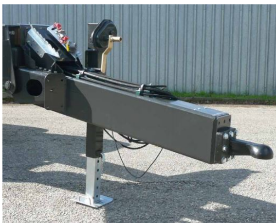
Slika 7. Ovješanje vučnog ruda prikolice [2]
