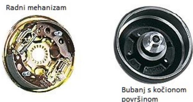
Slika 33. Glavni dijelovi kočionog sklopa[19]
