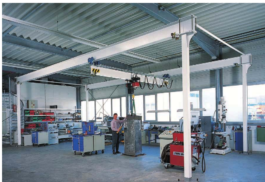
Slika 5. Primjer ovjesnog mosnog granika
