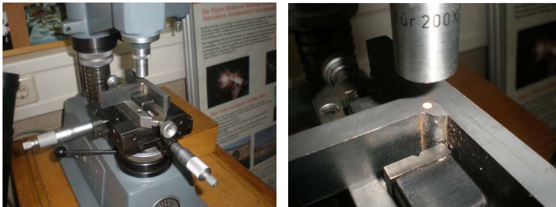
Slika 4.19 Ispitivanje tvrdoće na Vickers tvrdomjeru modela \text{HV}_{10}
