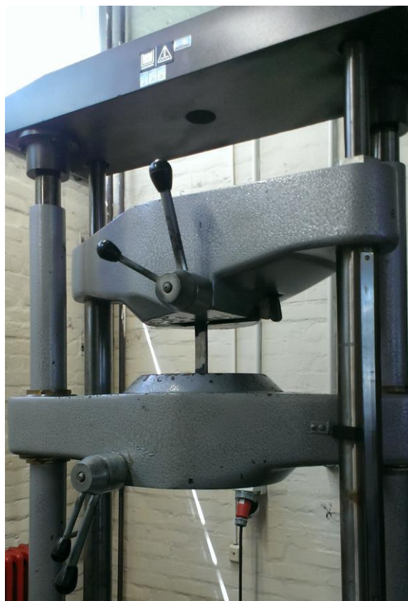
Slika 26 Kidalice EU 40 mod s epruvetom
