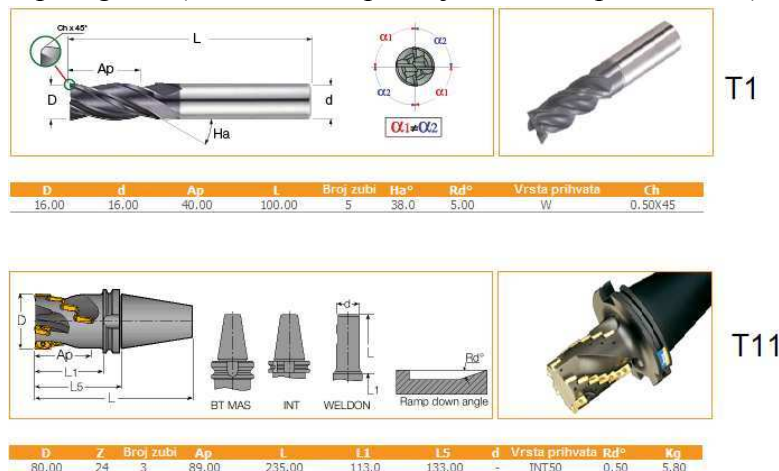
Slika 50. Dimenzije glodala T1 i T11
