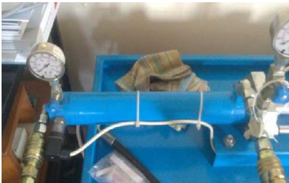
Slika 2.7 Pogonski dvoradni cilindar na laboratoriskom postavu
