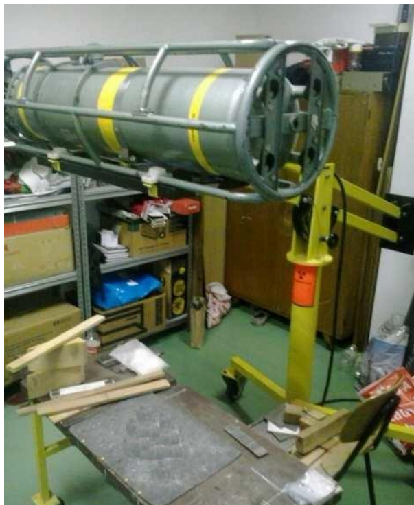
Slika 65. Rentgen u Laboratoriju za nerazorna ispitivanja
