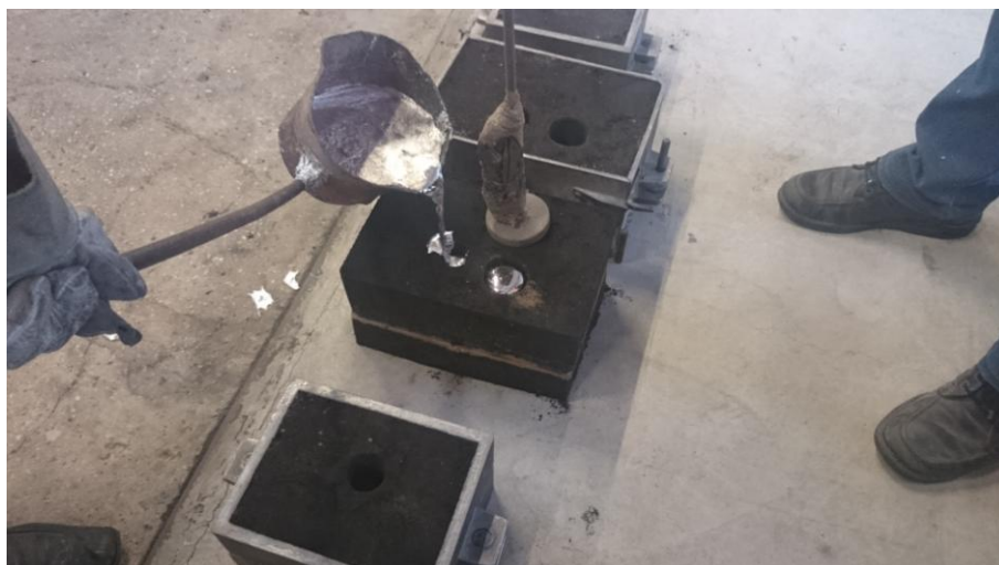
Slika 61. Postupak ulijevanja taline
