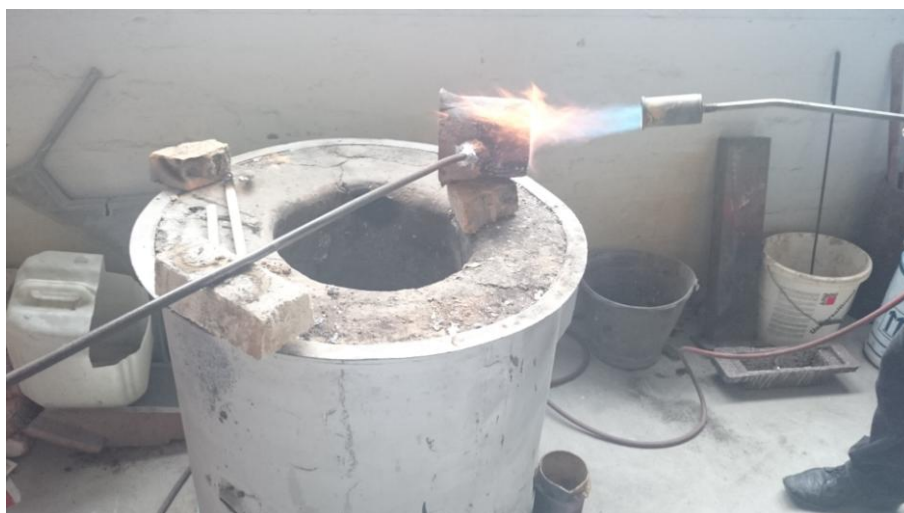
Slika 59. Zagrijavanje lonca za ulijevanje
