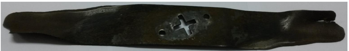
Slika 21. Nož na kojem su provedena ispitivanja (prikazana je gornja strana, koja je okrenuta prema osovini kosilice)
