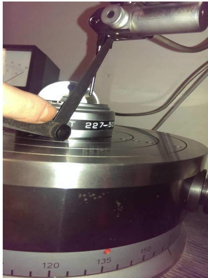
Slika 35. Osiguranje kuta ticala mjernim listićima
