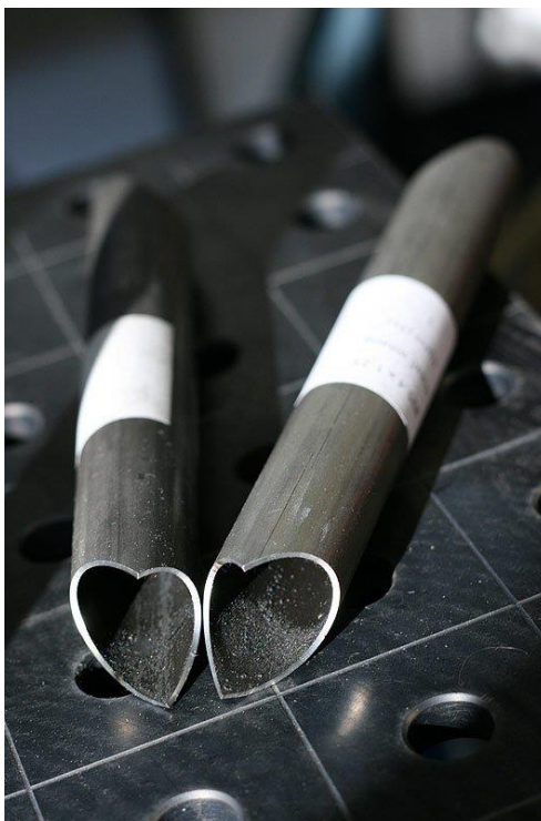
Slika 2.8. Cijevi pripremljene za zavarivanje
