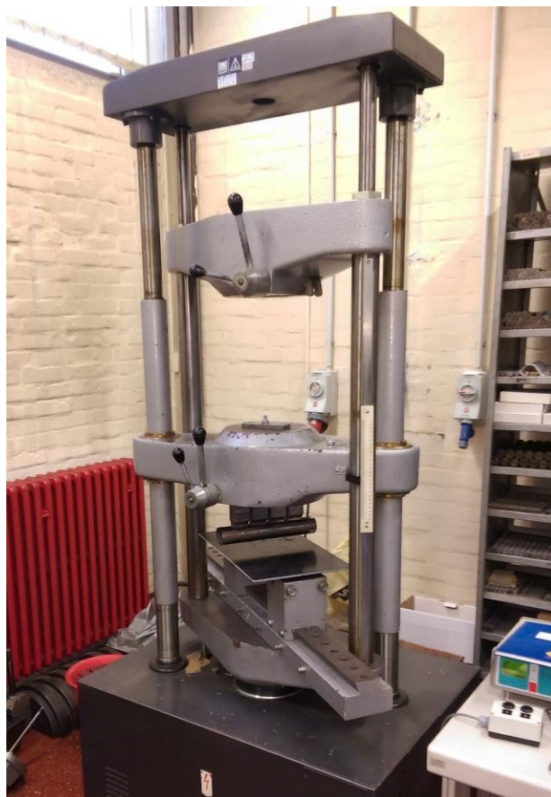
Slika 5.17. Postav spreman za ispitivanje savijanja
