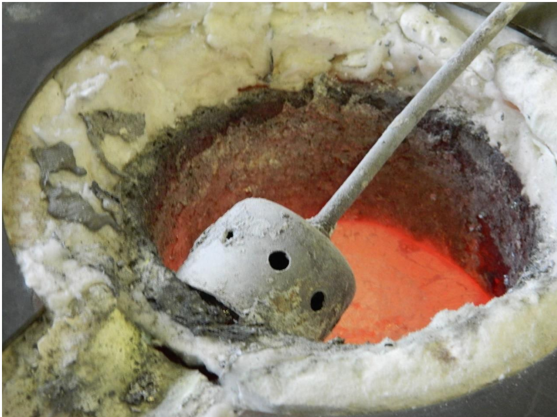
Slika 6.28. Grijanje modifikatora u zvonu za uranjanje
