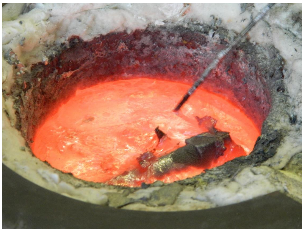
Slika 6.21. Uklanjanje troske s vrha taline
