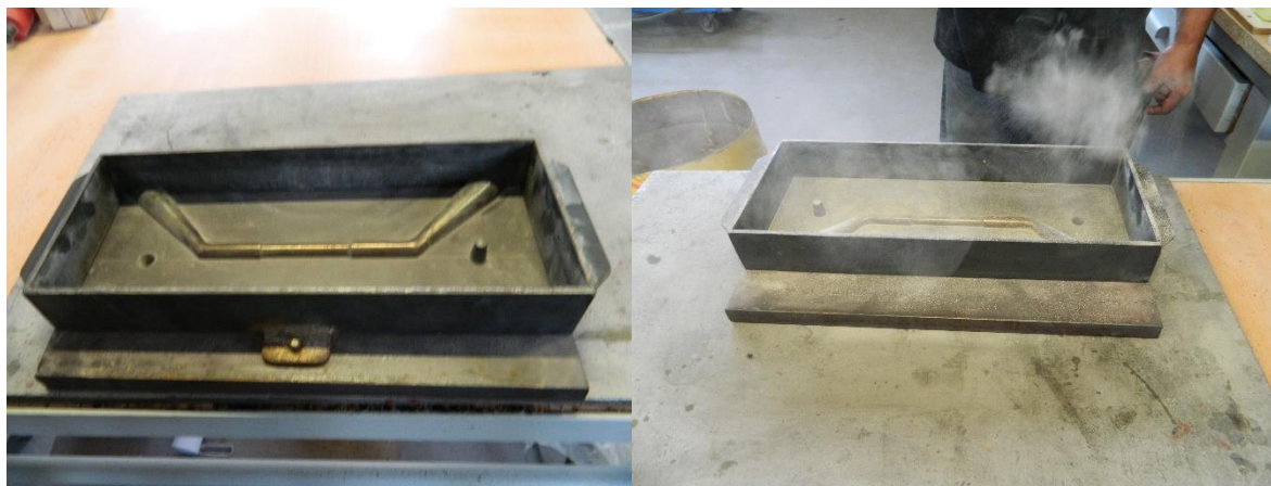
Slika 6.8. Kalupnik (lijevo), posipanje kalupnika likapodijem (desno)
