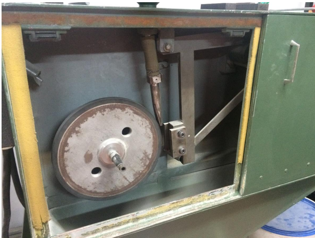
Slika 7.12 Uređaj za mjerenje otpornosti na abrazijsko trošenje metodom “suhi pijesak/gumeni kotač“
