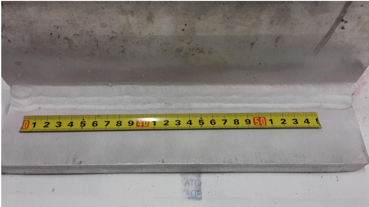
Slika 51: Pregled indikacija na ispitnom uzorku
