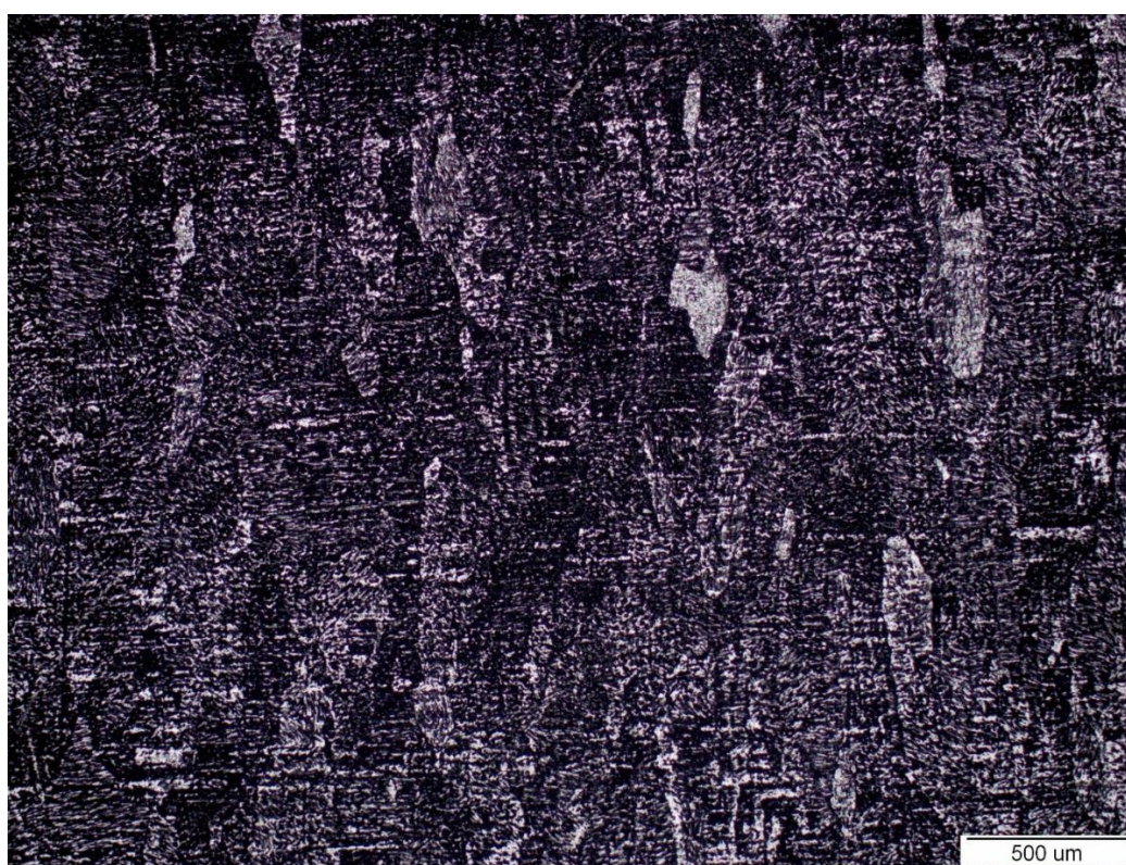
Slika 57: Mikrostruktura zone utjecaja topline
