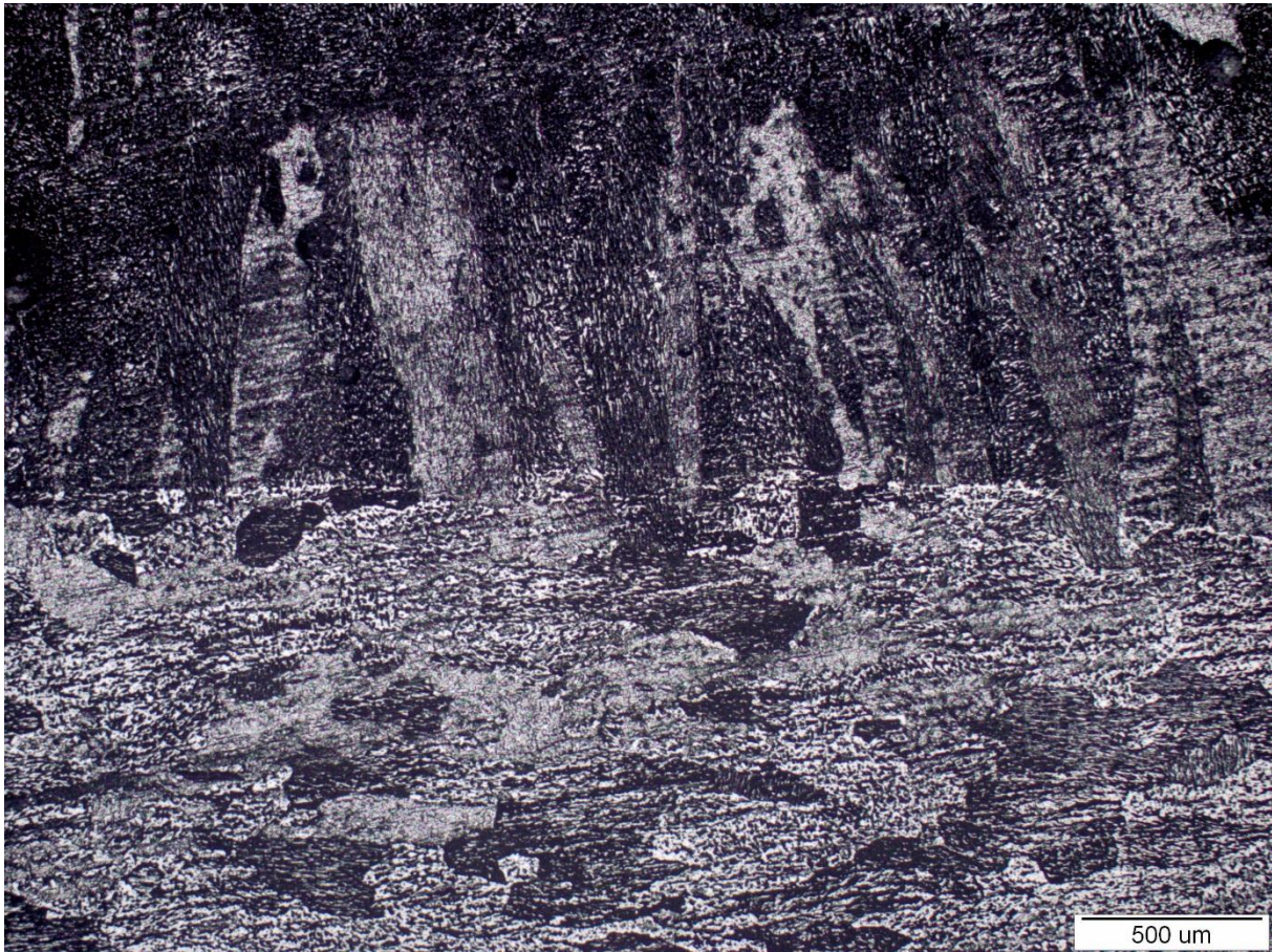
Slika 54: Greška naljepljivanja (povećanje 50x)
