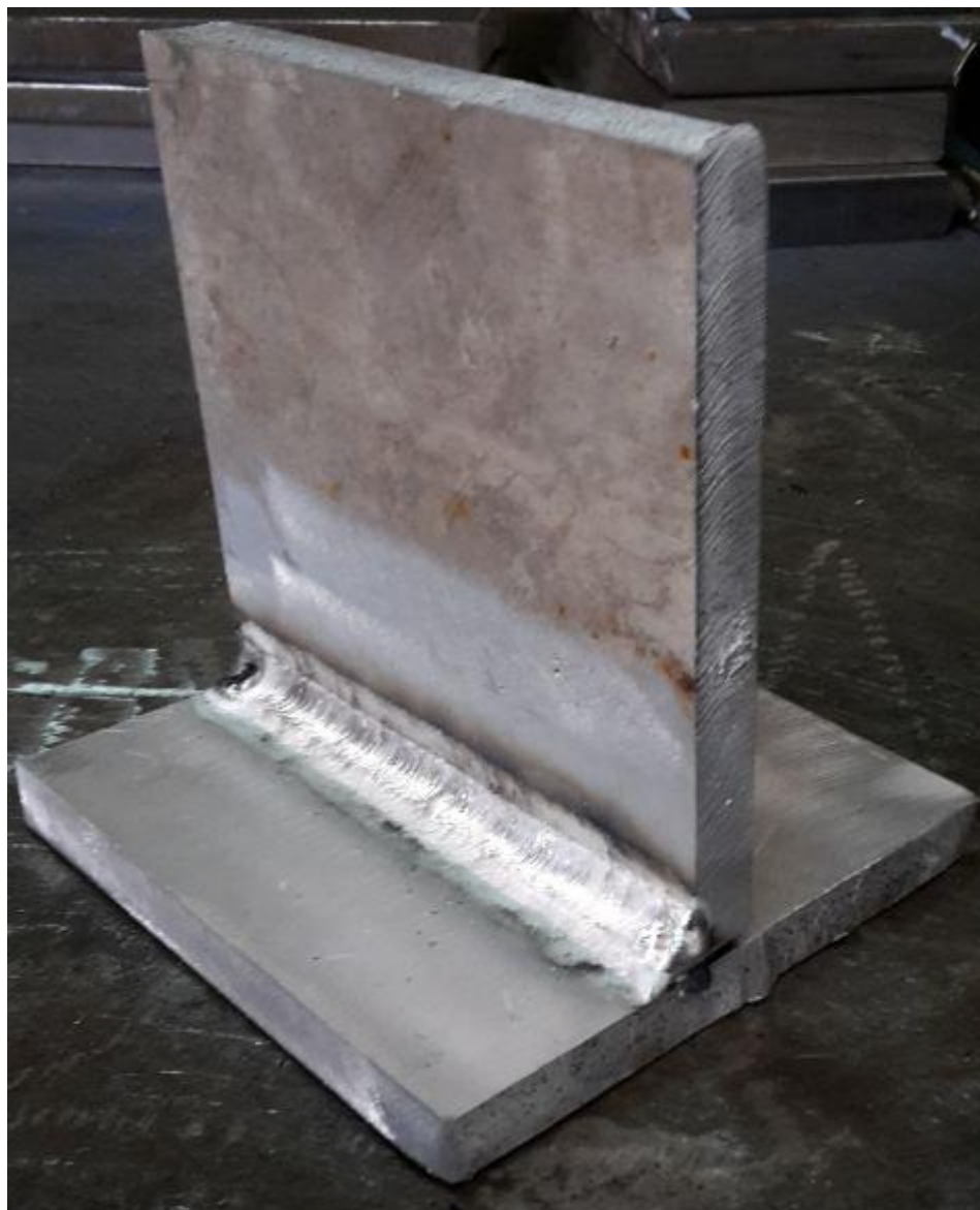
Slika 45: Ispitni uzorak za certifikaciju zavarivača
