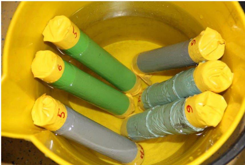
Slika 23. Ispitivanje u vodenoj otopini 3,5 % NaCl
