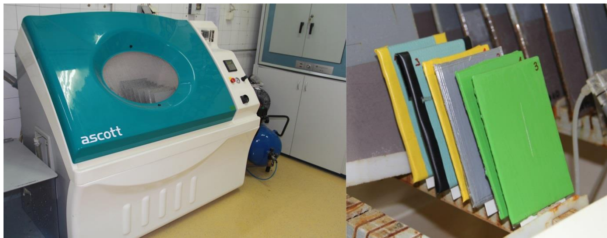
Slika 24. Slana komora Ascott model S450, Laboratorij za zaštitu materijala, FSB
