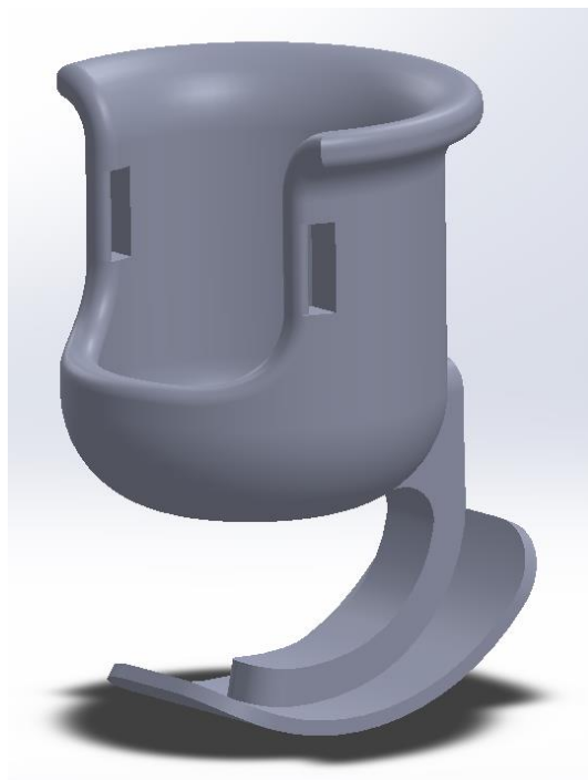
Slika 27. 3D model proteze iz jednog komada
