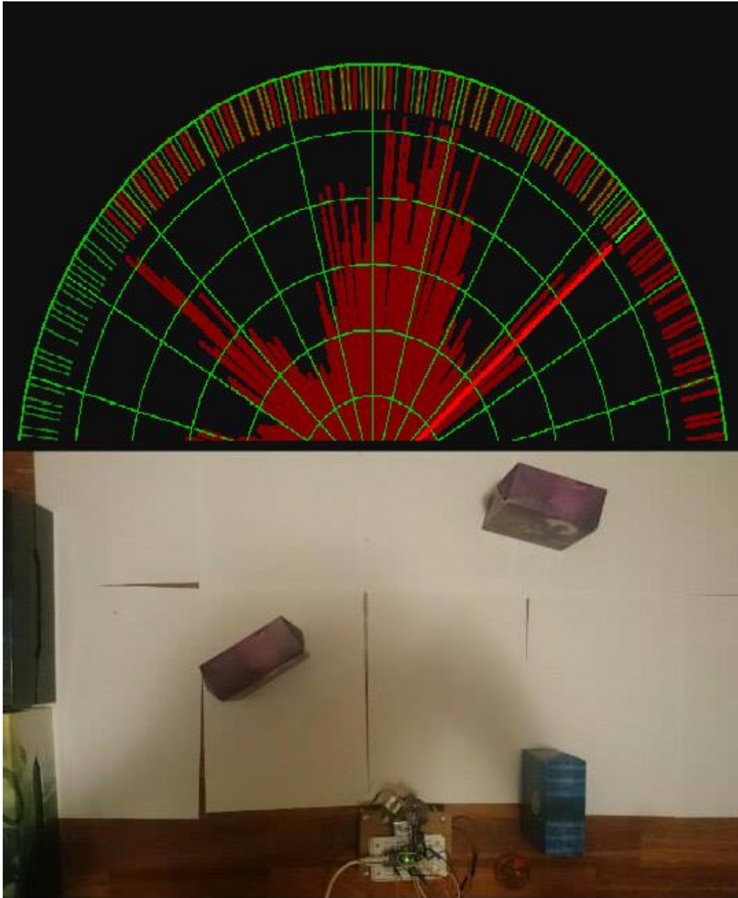
Slika 14. Usporedba mjerenja na 10 ms po stupnju zakreta
