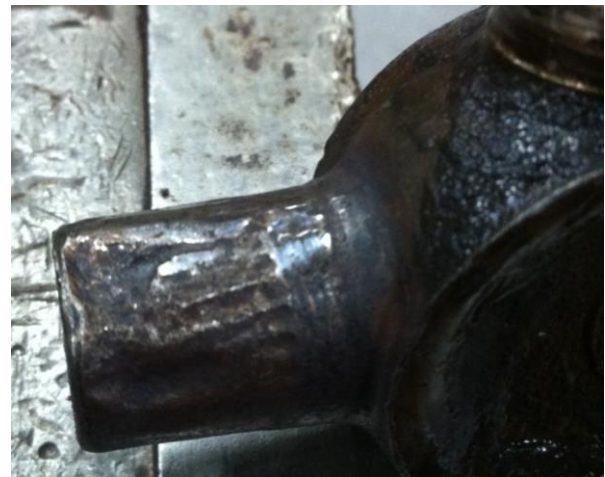
Slika 20. Oštećenje uslijed nedostatka maziva [17]
