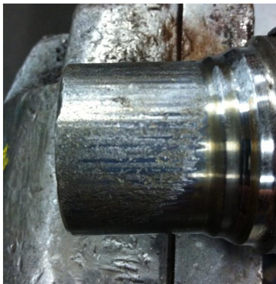
Slika 23. Oštećenje zbog prisustva vode i prljavštine [17]
