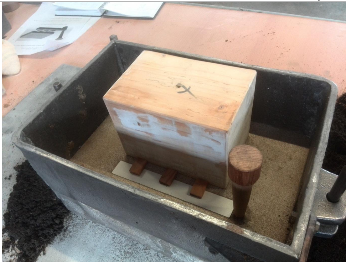
Slika 57. Postavljanje elemenata uljevnog sustava u gornji dio kalupa
