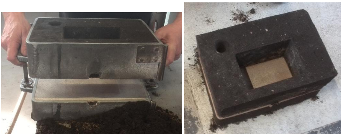
Slika 61. Sklapanje gornjeg i donjeg dijela kalupa
