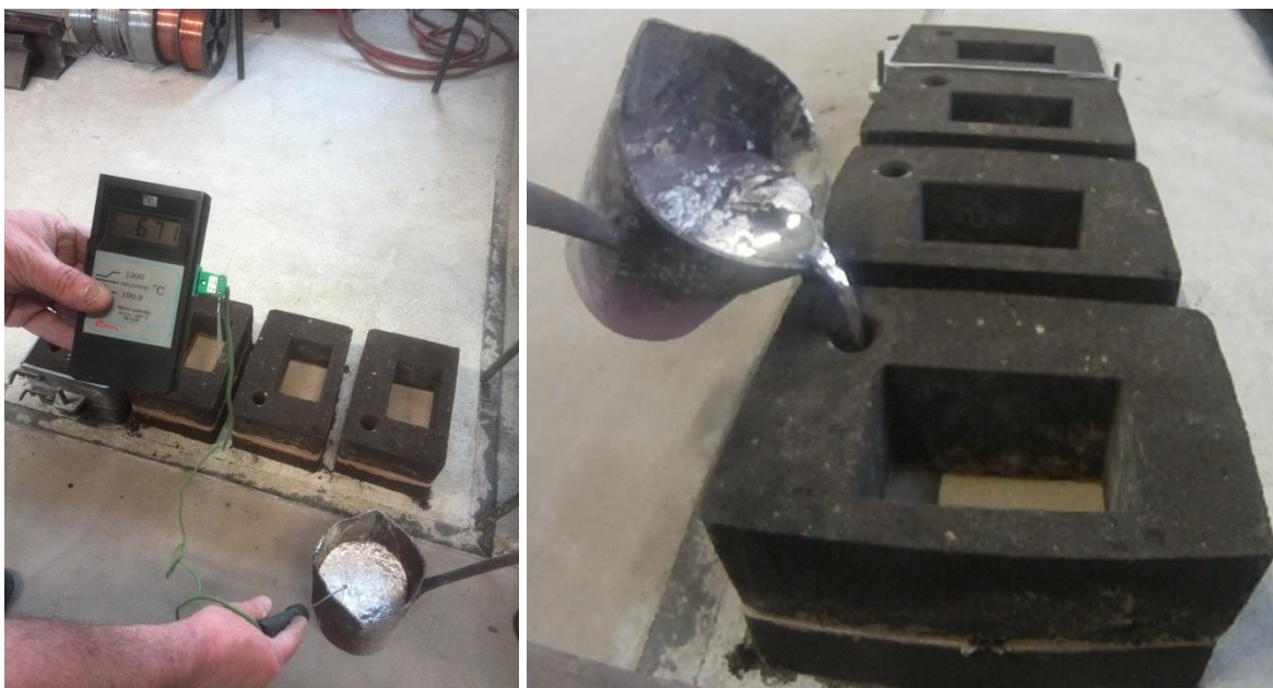
Slika 67. Mjerenje temperature kod kalupa i ulijevanje
