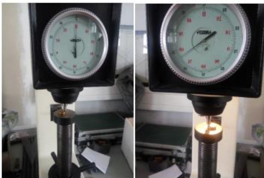
Slika 6.1. Ispitivanje adhezivnosti na Rockwell-ovom tvrdomjeru [18]
