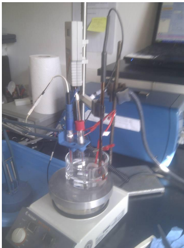
Slika 9.10. Ispitna oprema za elektrokemijska AC ispitivanja
