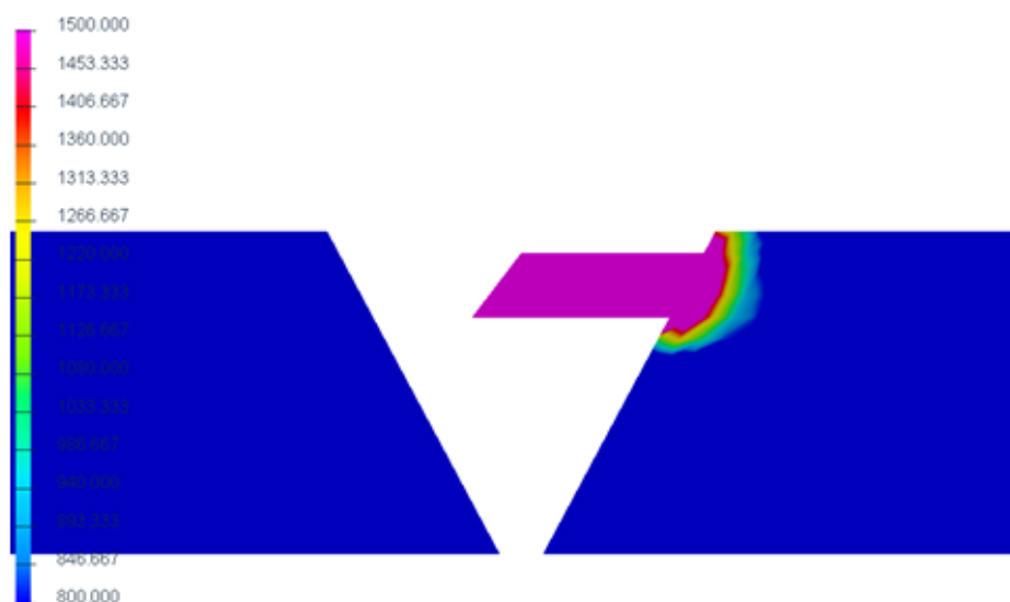
Slika 70. Kalibrirani unos topline četvrtog prolaza
