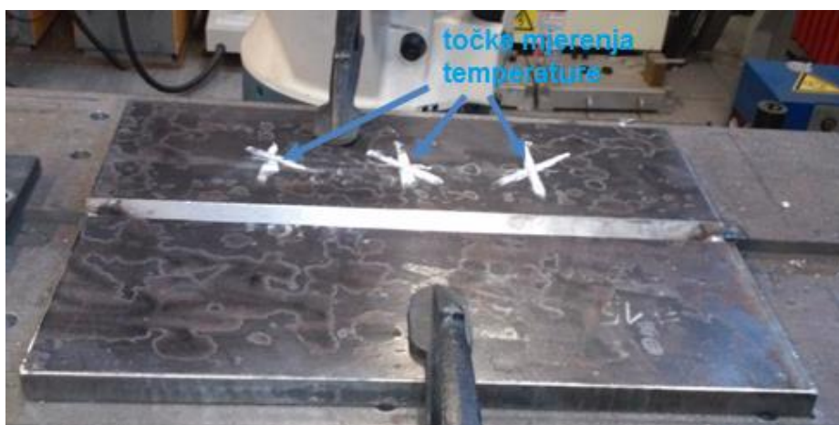
Slika 39. Pripremljeni spoj 2 za zavarivanje
