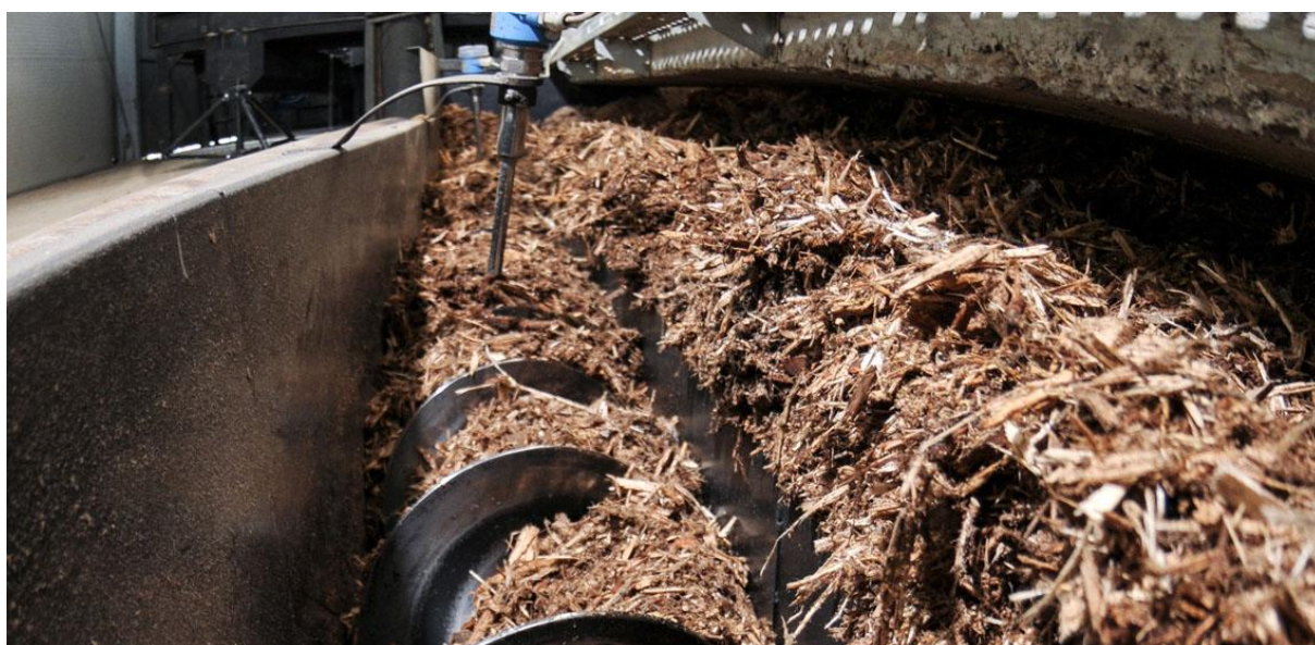
Slika 6. Prijenos biomase pužnim vijcima [7]
