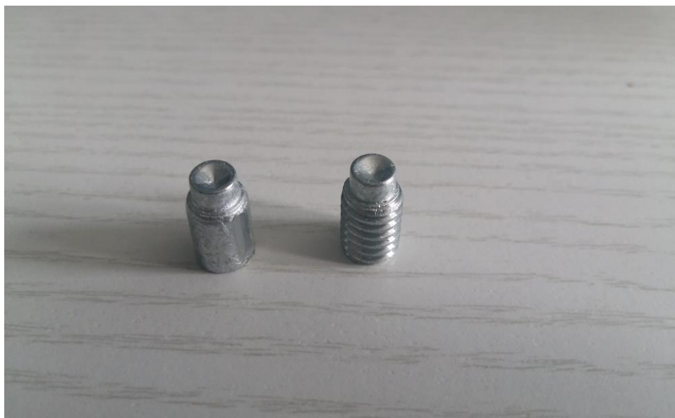
Slika 11. Dio C prije i nakon rezanja navoja
