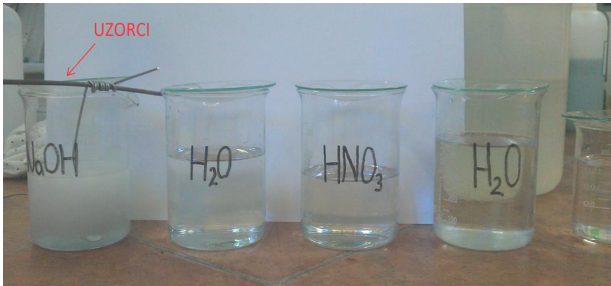
Slika 25. Kemijska obrada površine uranjanjem
