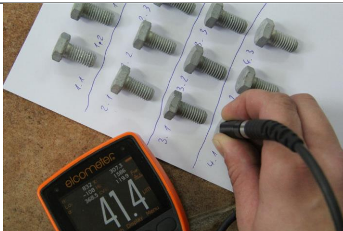
Slika 13. Mjerenje debljine prevlake cinka uređajem ELCOMETER 456/4
