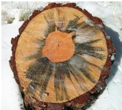
Slika 20. Gljivice na poprečnom presjeku drva, [10]
