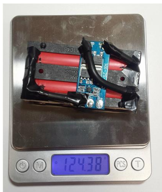
Slika 49. Masa baterijskog paketa
