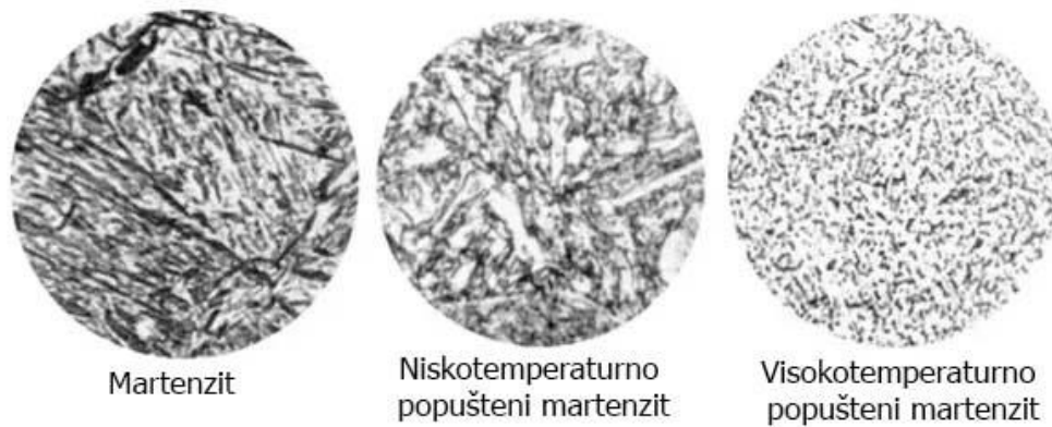
Slika 7. Martenzit pri različitim temperaturama popuštanja [7]
