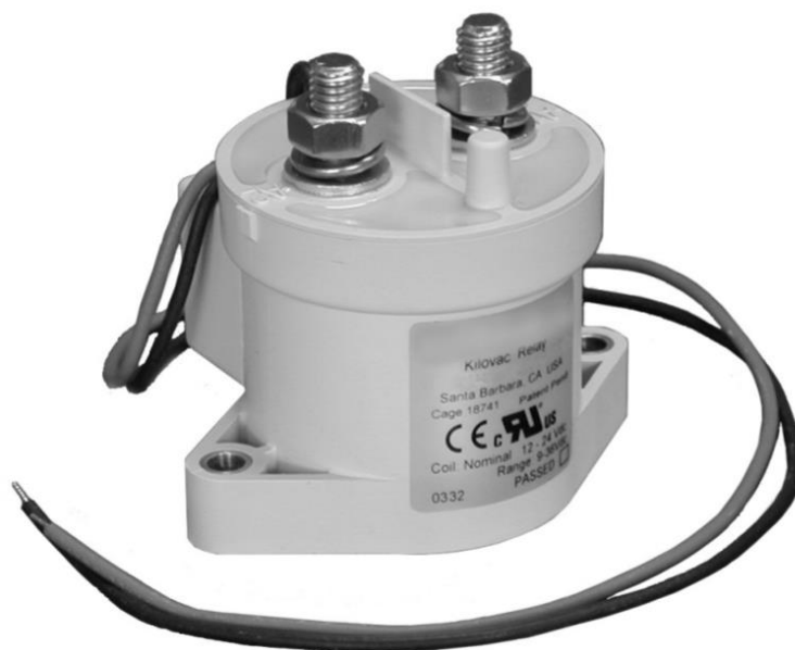
Slika 23. Sklopnik za visoke napone korišten u bolidu [17]
