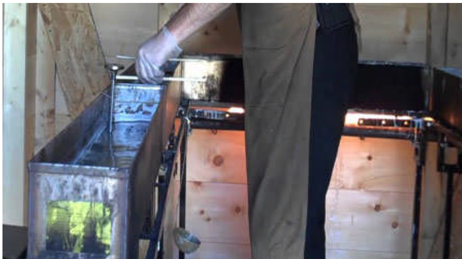
Slika 6.4. Postupak bruniranja cijevi lovačkog oružja [13]
