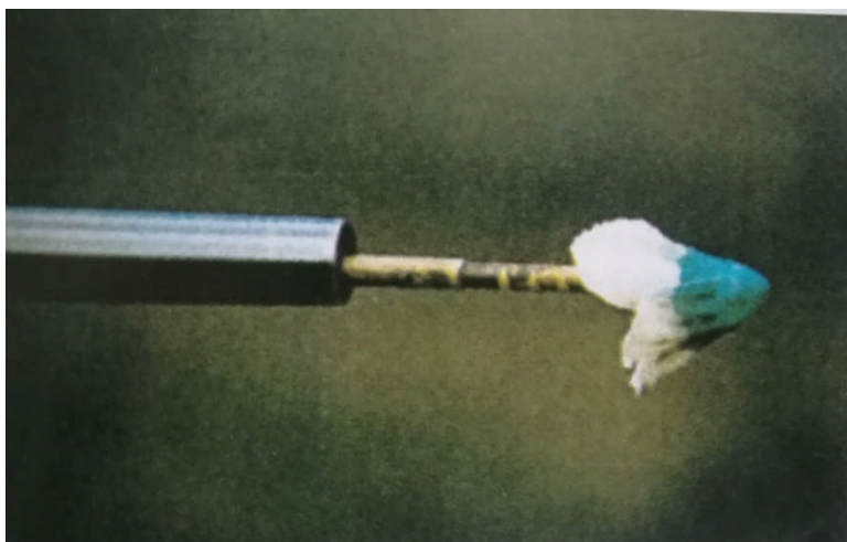
Slika 7.1. Obojena krpica pokazatelj prisustva nečistoća u cijevi [14]
