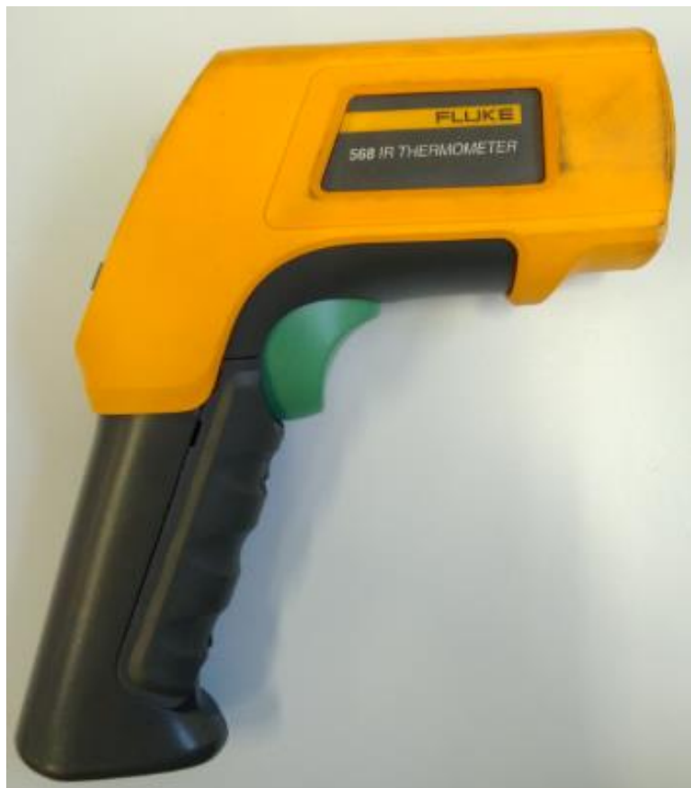
Slika 22. Fluke 568 uređaj za mjerenje međuprolazne temperature
