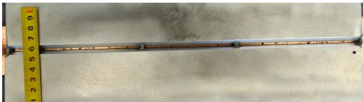
Slika 23. V priprema spoja i pripoji napravljeni TIG postupkom
