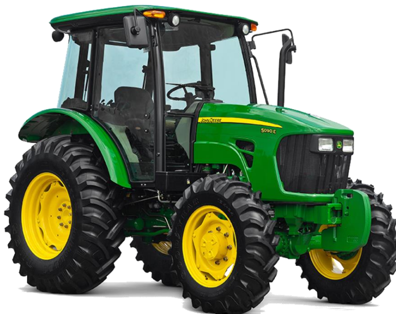
Slika 3. Dvoosovinski traktor s pogonom na sva četiri kotača
