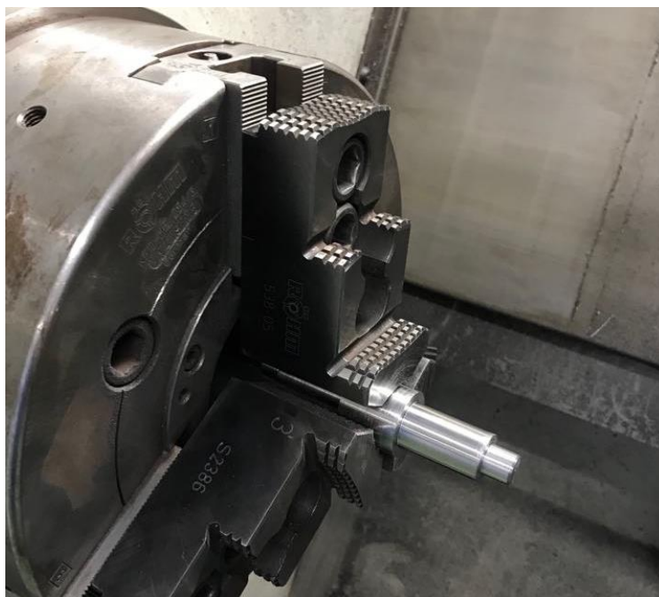
Slika 22. Tokarenje osnovnog oblika osovine 1 na CNC tokarilici
