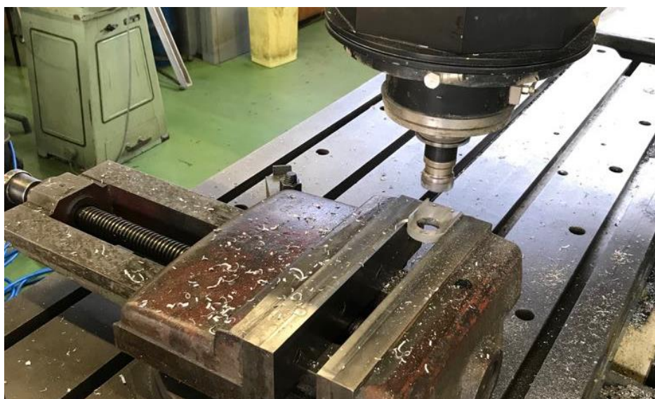
Slika 19. Postupak čeonog glodanja držača ležaja
