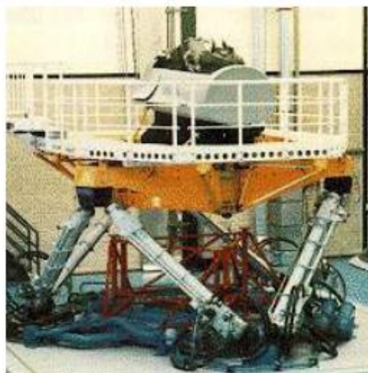
Slika 1. Goughov stroj za testiranje guma (lijevo), Stewartov simulator leta (desno) [1]
