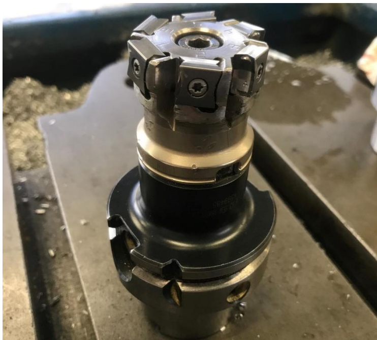
Slika 31. ISCAR glodalo za poravnavanje
