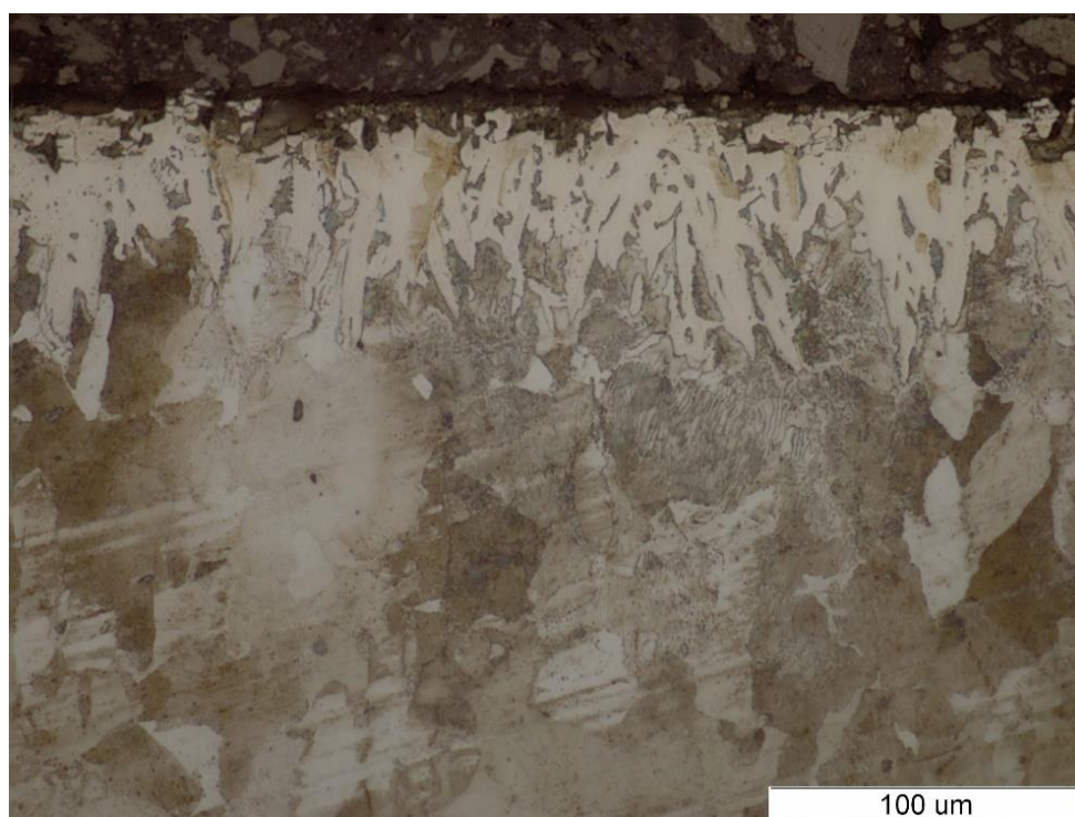
Slika 21. Mikrostruktura uzorka 2 u nagriženom stanju pri povećanju od 500x
