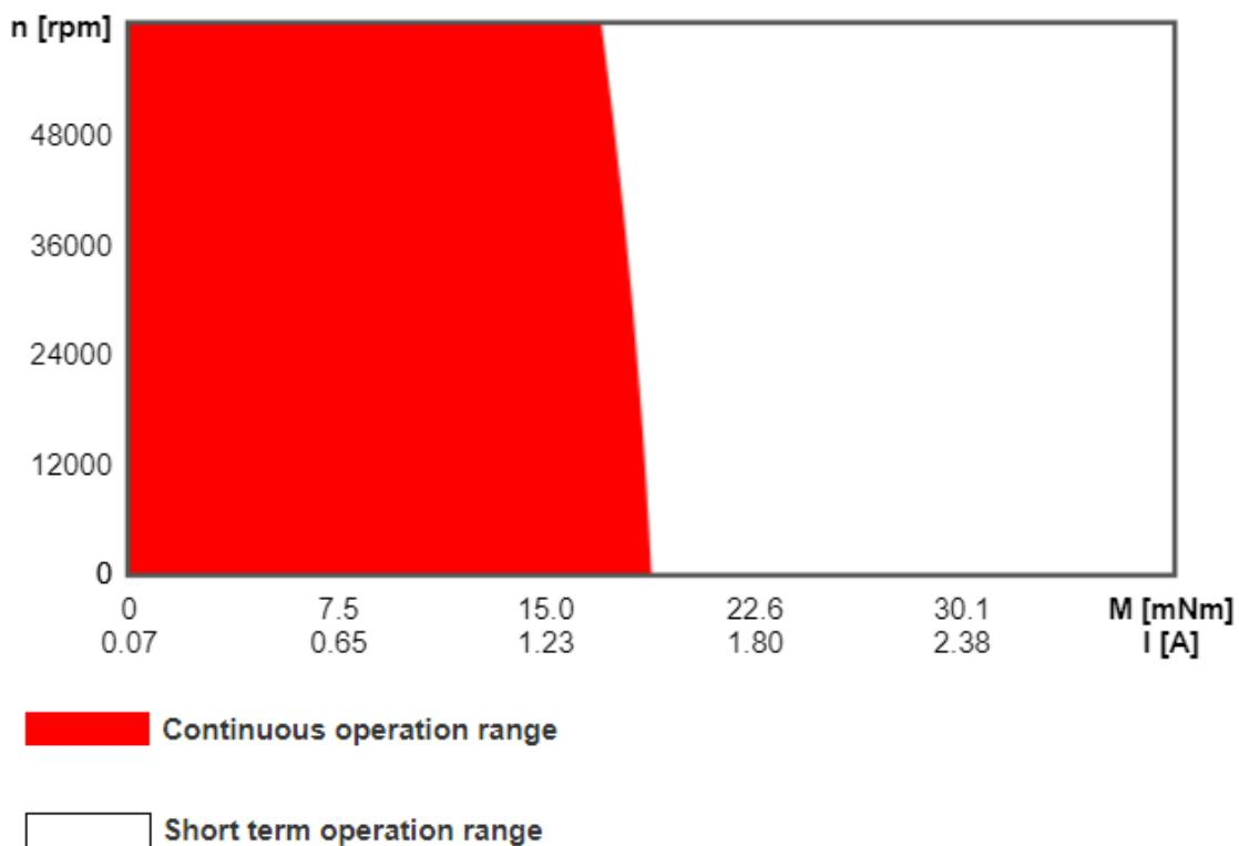
Slika 21. Radno područje Maxonovog motora 386660 i 386675 [5]
