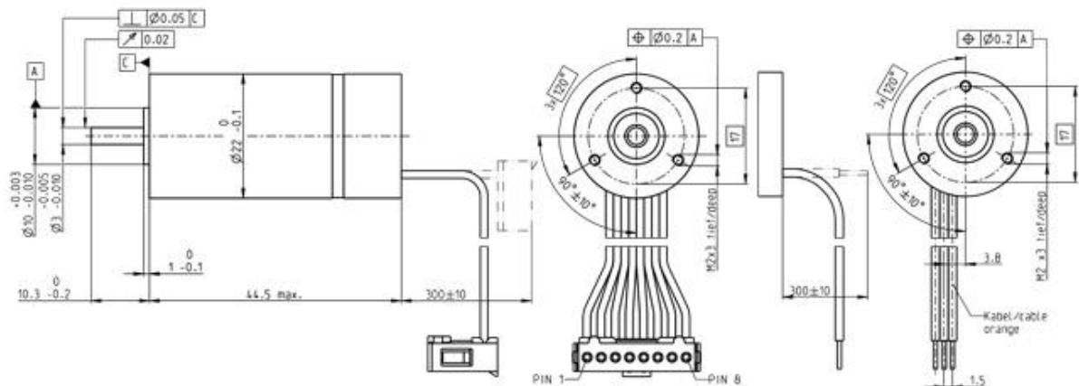
Slika 20. Dimenzije motora Maxon 386660 [5]
