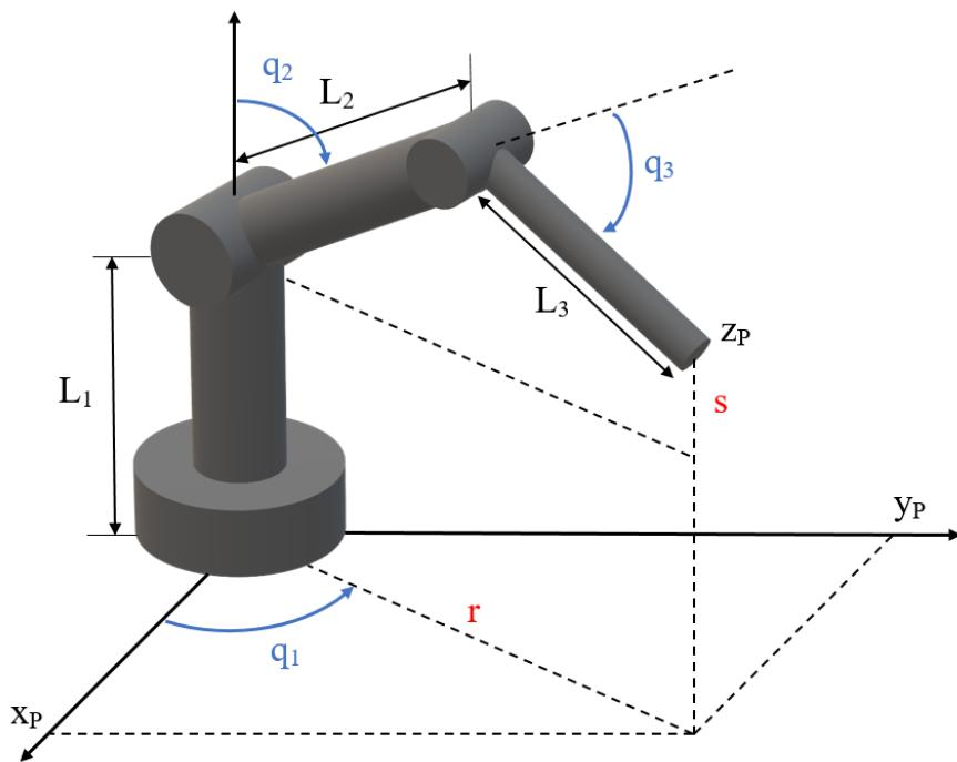
Slika 30. Opći prikaz RRR robota.
