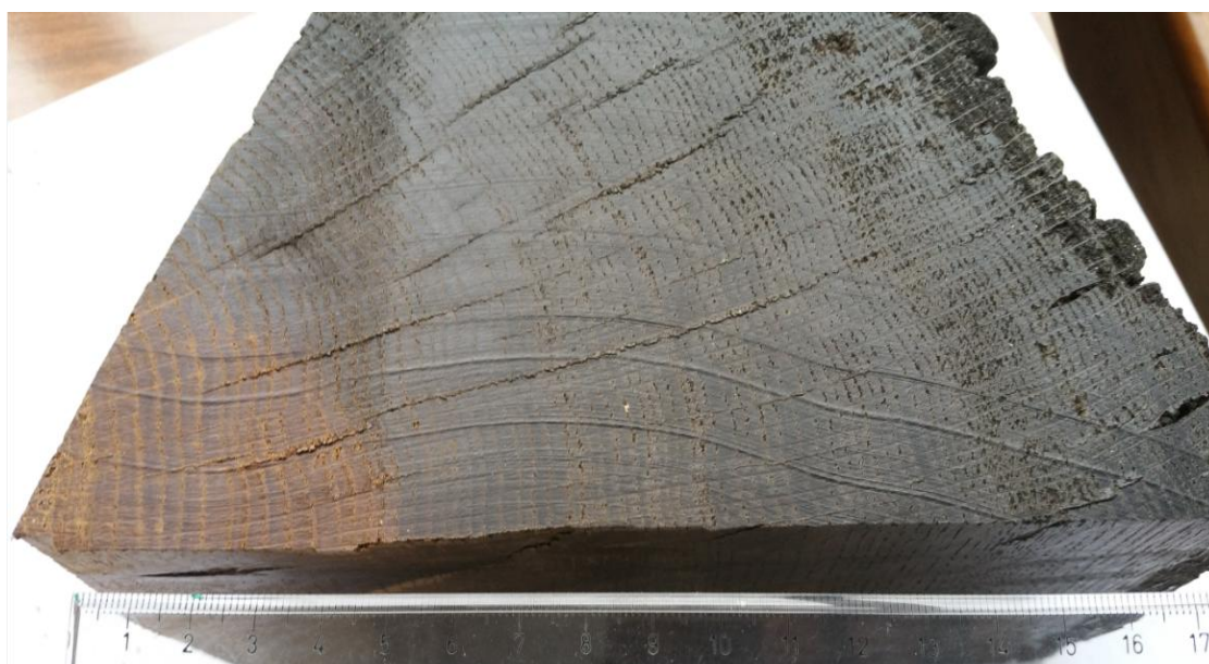
Slika 35. Makrostruktura poprečnog presjeka drva hrasta starosti 5800. Godina
